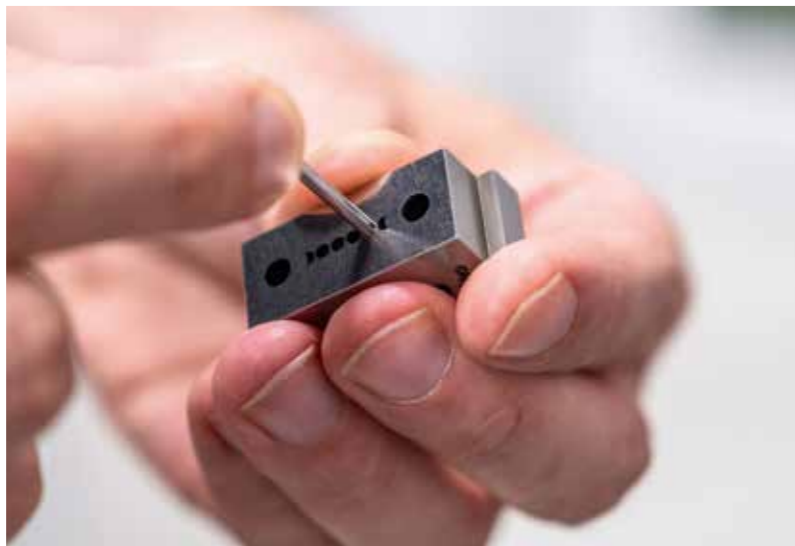
Bei den Drahterodiermaschinen verwenden wir einen japanischen Ansatz mit sehr kleinen Werkzeugen und einer Toleranz von 1-2 Tausendstel, um die bestmögliche Passgenauigkeit zu erreichen.
