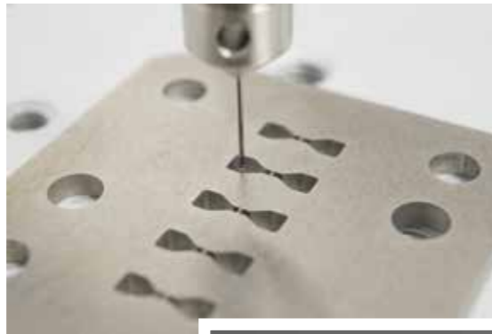
Selbst kleinste Hohlräume können dank fortschrittlicher Messtaster und Koordinatenmessmaschinen vermessen werden.
