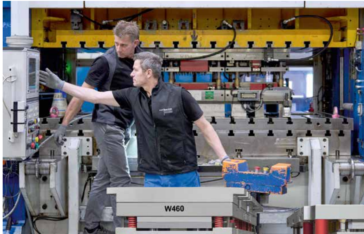
Einstellarbeiten an einem komplexen Folgeverbundwerkzeug
